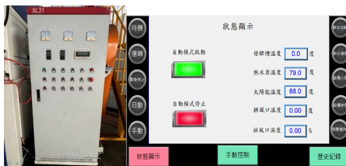
廢棄太空包乾燥設備及可視化系統
